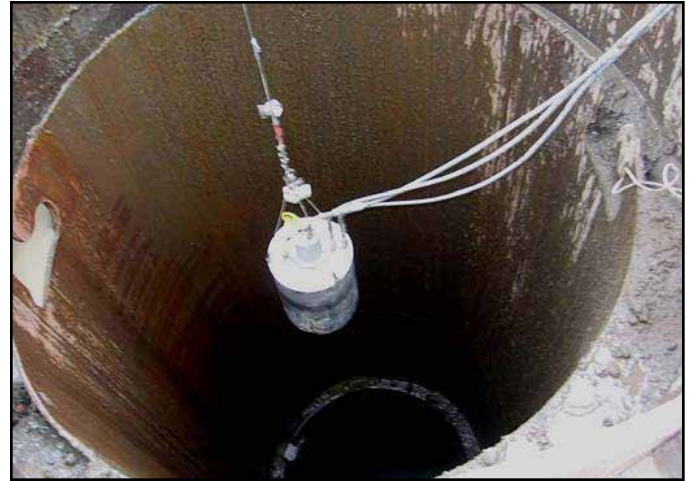
Figura 10: Dispositivo de inspección de fustes perforados
